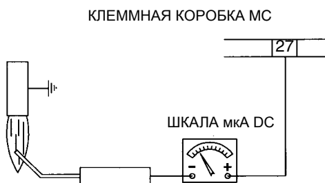
Рис. 30 - Контроль пламени с помощью электрода
