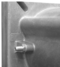
Штуцер для замера давления воздуха вентилятора
