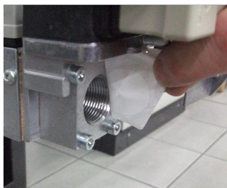
8) Снять заглушку из Труба ГАЗОВОЙ рампы;
