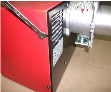
1) Снять кожух, ослабив 4 винта;
