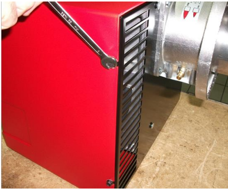
1) Снять кожух, ослабив 4 винта;
