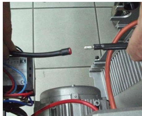
3) Отсоединить кабель электрода ионизации от от разъема;
