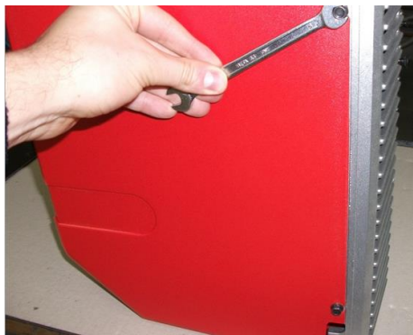
1) Снять кожух, ослабив 4 винта;
