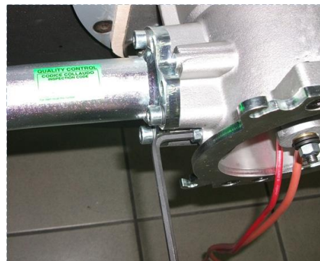
6) Отвинтить 2 винта см. рис.6-7;
